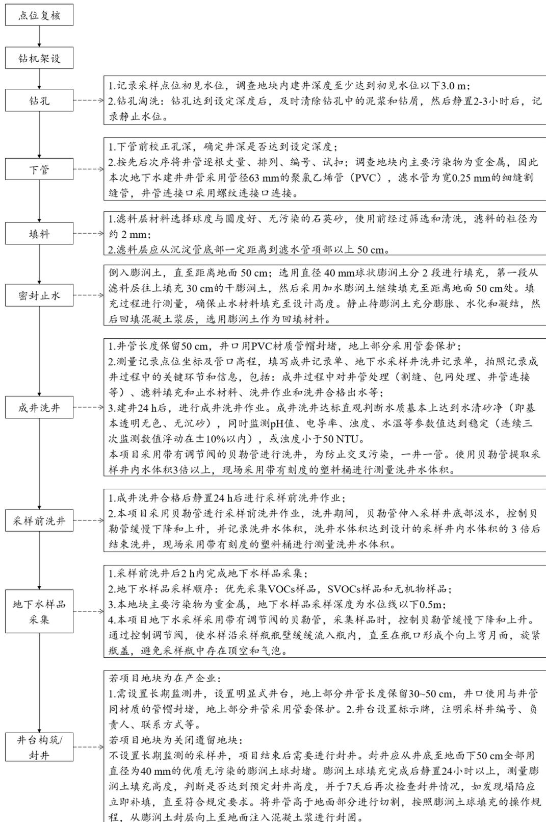
图 7.3-1 地下水采样井建井及采样流程
